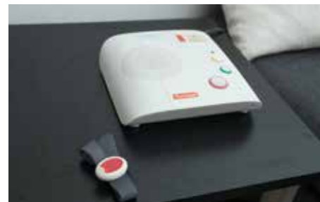
Sender und Basisgerät der Rufhilfe
